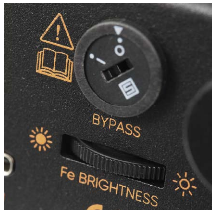
Niewielkie pokrętło służy do regulacji intensywności podświetlenia logo na przednim panelu. Mały przycisk aktywuje tryb bypass (z pominięciem regulacji głośności na wyjściach RCA i XLR).
